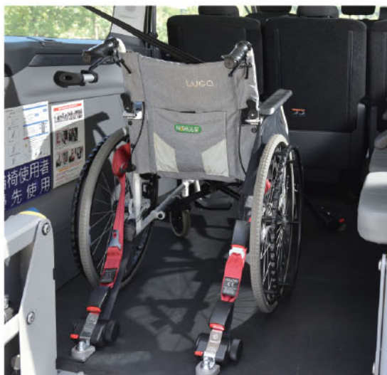
3 將輪椅乘客推入車內輪椅區定位，安裝輪椅固定 裝置及繫上輪椅乘客安全帶
