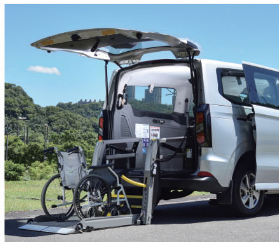
2 輕按遙控器IN按鈕解除鎖定，隨後按下OUT按鈕 展開升降平台至水平後，按下▼下降按鈕至地面
