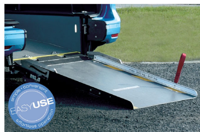
* 單片式輕量化鋁製斜坡板，可乘載350公斤
