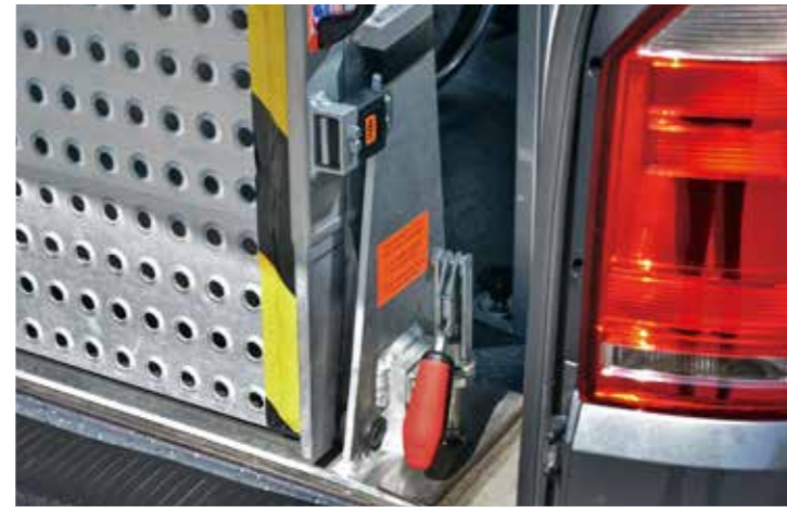
* 斜坡道側邊有固定按鈕及旋轉固定拉把，簡單易操作
