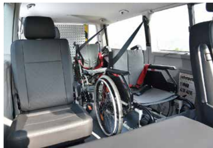
* 7人座車型第二及第三排配置原廠單人座椅，寬敞空間提供可承載2位輪椅乘客 (為座位配置示意圖，內裝以實車為準)
